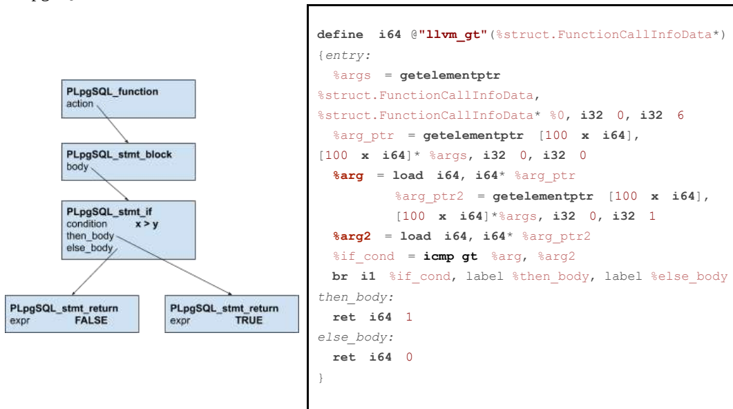
Рис. 5. Слева – абстрактное синтаксическое дерево функции gt , справа – сгенерированный для этой функции LLVM IR
