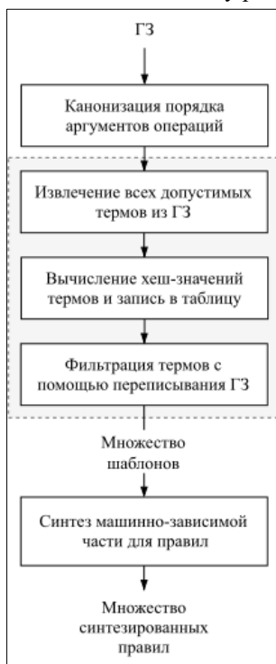
Рис. 3. Метод синтеза правил машинно-зависимой оптимизации Fig. 3. Method for synthesizing rules of machine-dependent optimization
