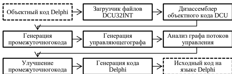
Рисунок 1. Схема декомпиляции объектного кода Delphi
